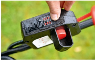
➤ Makitan työkahvassa on akkujen varaustilan kertova mittaristo.
