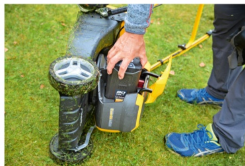
➔ Stigan akku on sijoitettu erikoisesti sivulle. Käytännössä leikkuri on kaadettava kyljelleen akun vaihdon ajaksi.
