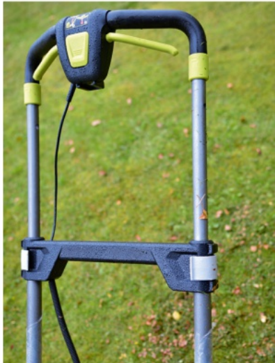
➤ Makitan työkahvassa on akkujen varaustilan kertova mittaristo.
