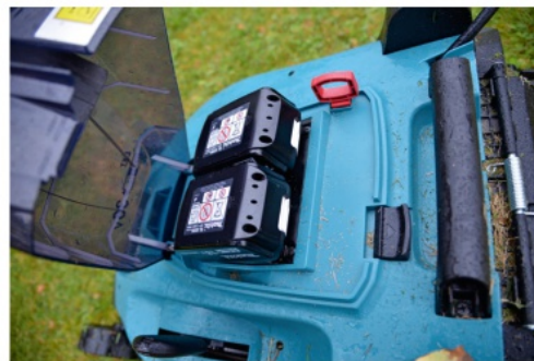
➔ Sekä Makita (kuvasa), että Einhell tarvitsevat toimiakseen molemmat akut.
